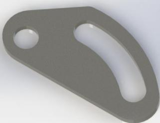
压滤机的滤板组打开时，需要连接板将各个滤板拉开。在立式压滤机中，连接板的质量极其重要，一旦发生破裂，将会损坏滤板并造成严重损失。所以，需要定期检查连接板有无裂缝，并及时更换有安全隐患的连接板。
